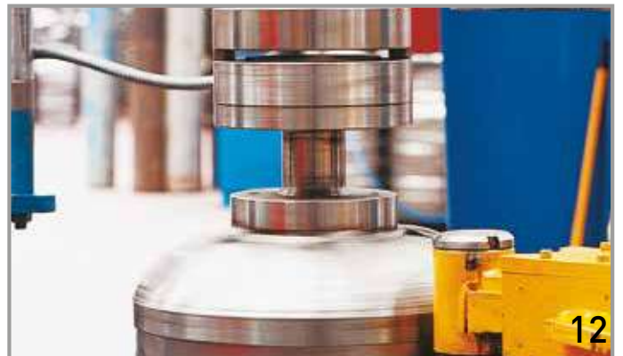
12. Αυτόματη διαδικασία περιμετρικής κοπής και διαμόρφωσης καπακίων / Automated cutting and final formation procedure of the caps
