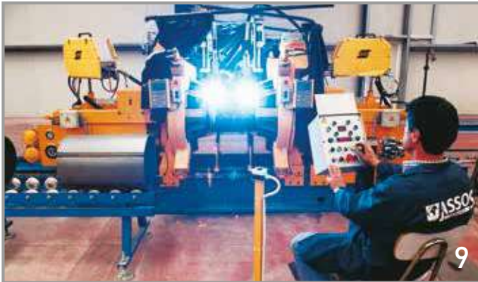
9. Ρομπότ προσαρμογής καπακίων / Superior and inferior cap fitting and welding machine
