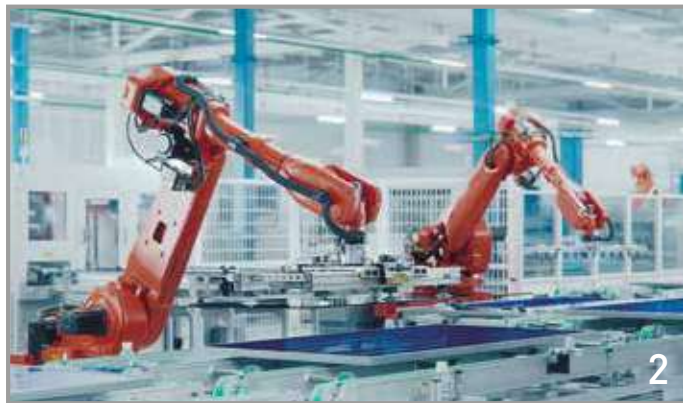
2. Συναρμολόγηση συλλεκτών / Collectors assembly
