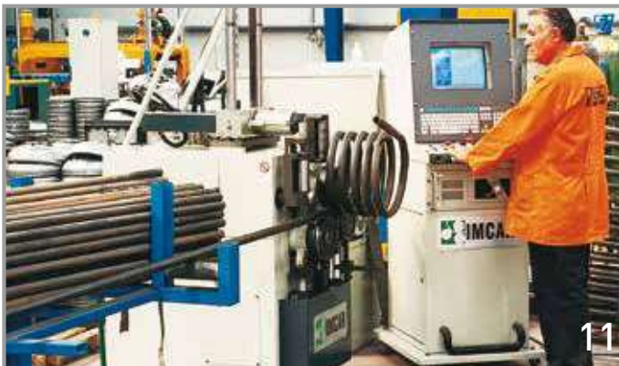
11. Αυτόματη παραγωγή εναλλάκτη με ηλεκτρονικούς υπολογιστές / Computerised automated heat exchanger production
