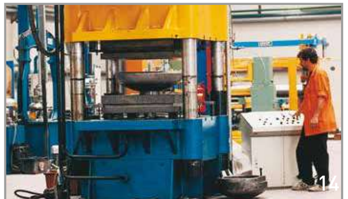
14. Υδραυλική πρέσα διαμόρφωσης καπακίων / Hydraulic press for forming superior and inferior caps
