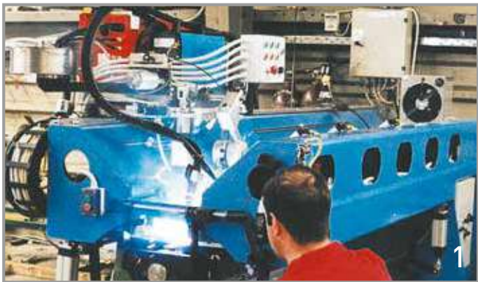
1. Αυτόματη μηχανή οριζόντιας συγκόλλησης των δεξαμενών / Automatic welding machine of the storage tank
