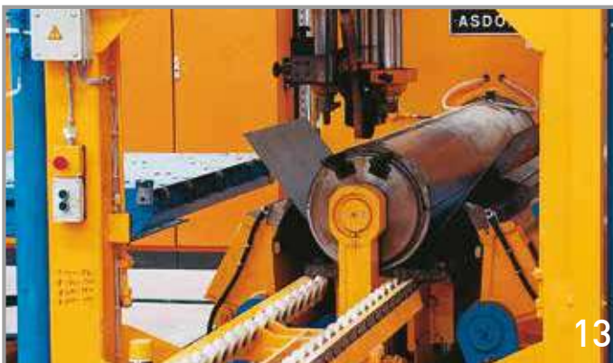
13. Ρομπότ διαμόρφωσης και συγκόλλησης κυλίνδρων για μέγιστη ακρίβεια και ποιότητα / Cylinder forming and welding machine for maximum precision and quality
